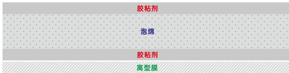
VHB™ 胶带是 3M 采用独特的无溶剂制造技术生产的聚丙烯酸酯双面泡绵胶带，泡绵芯材和表层的胶粘剂全部由聚丙烯酸酯类粘弹体构成，而非在泡棉芯材的两面涂布胶粘剂，**这也是 VHB™ 胶带产品与常见泡绵胶带的最大不同，可以形象地称之为“固态胶水”。**这种特殊的结构赋予了胶带特殊的整体粘弹性，胶带整体能有效地将粘接接头里面的应力通过胶带的力学松弛耗散掉，从而有效地保护粘接线。
